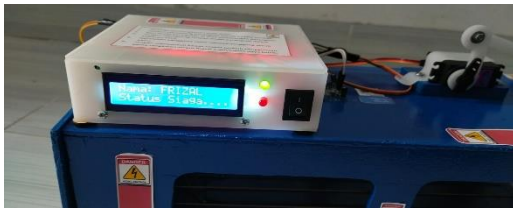
Gambar 9. Tampilan Alat Perangkap Tikus dalam Keadaan Aktif
